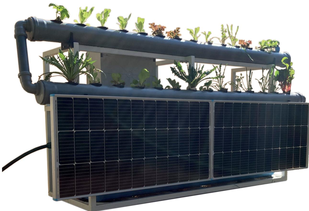
Il sistema per la coltivazione idroponica organica "outdoor" è adatto agli spazi aperti come cortili, serre, giardini o terrazzi; è configurato per la coltivazione NFT (Nutrient Film Technique) con 28 fori in 2 tubi sovrapposti in polipropilene (PP), di lunghezza 2 m e diametro 110 mm, un serbatoio da 300 L in PP, 1 pompa di circolazione per acqua a bassa tensione (12 V) 600/800 L/h 4/6 metri di prevalenza con relativo temporizzatore d'accensione e 1 pompa aeratore (12V) 150 L/h.
