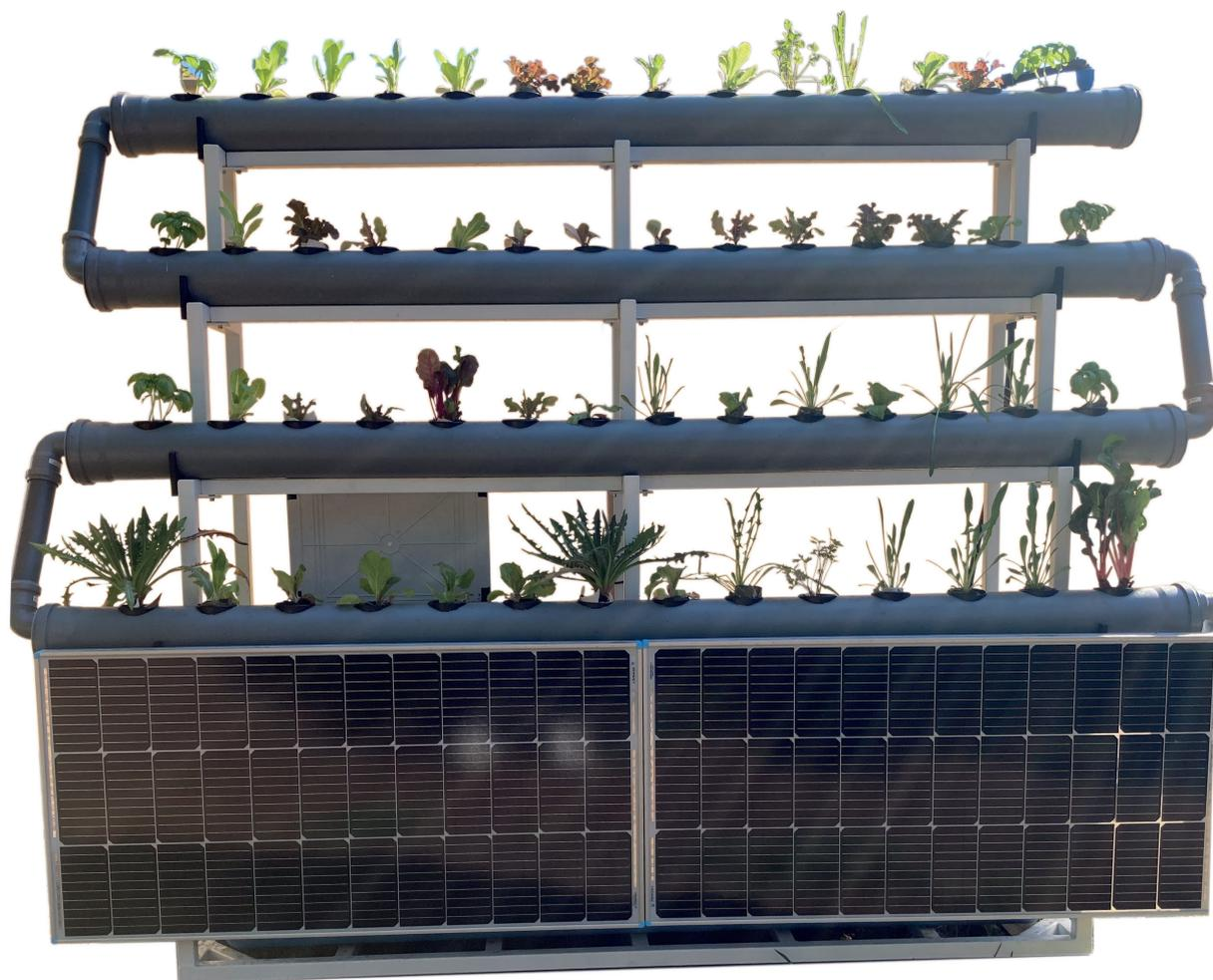
Il sistema per la coltivazione idroponica organica "outdoor" è adatto agli spazi aperti come cortili, serre, giardini o terrazzi; è configurato per la coltivazione NFT (Nutrient Film Technique) con 56 fori in 4 tubi sovrapposti in polipropilene (PP), di lunghezza 2 m e diametro 110 mm, un serbatoio da 300 L in PP, 1 pompa di circolazione per acqua a bassa tensione (12 V) 600/800 L/h 4/6 metri di prevalenza con relativo temporizzatore d'accensione e 1 pompa aeratore (12V) 150 L/h.
